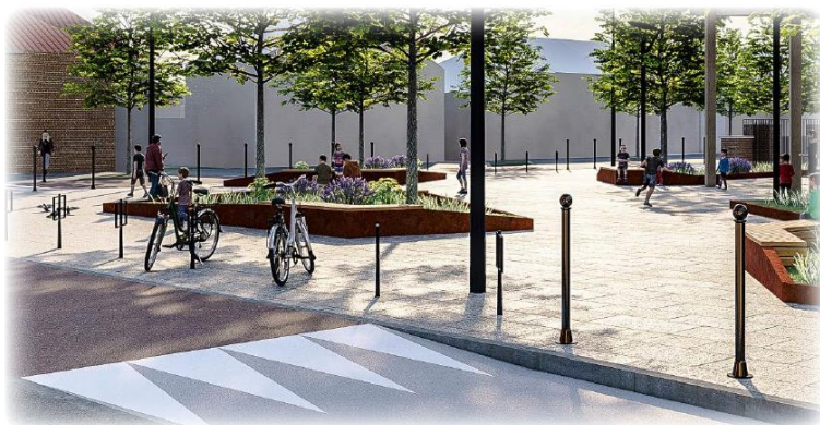
A la sortie du plateau, la voie nouvelle adopte un profil plus classique avec des bordures qui délimitent les trottoirs de la chaussée circulée. Le revêtement change de couleur pour marquer cette transition.
