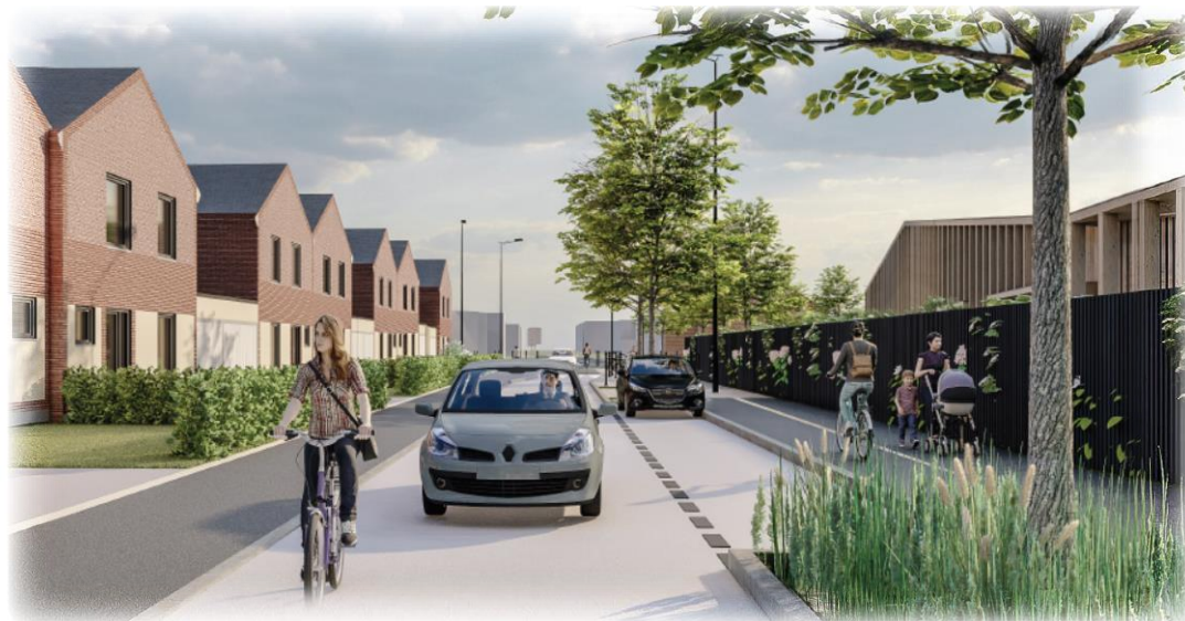
Une voie à sens unique avec une piste cyclable unilatérale sur le trottoir côté école, et des trottoirs confortables - Des espaces plantés qui infiltrent les eaux de pluie
